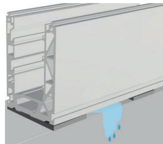
Drainage von Wasser und Kondensat durch integrierte Abflusskanäle.
