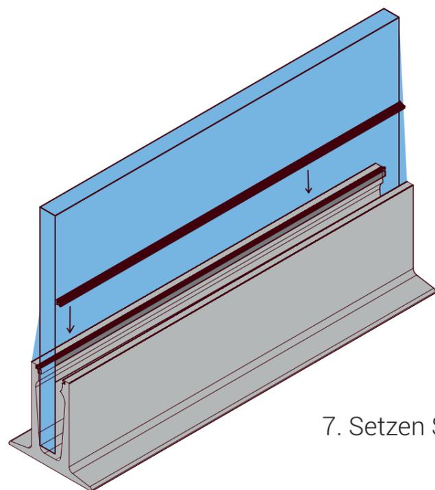
7. Setzen Sie die Innendichtung ein.
