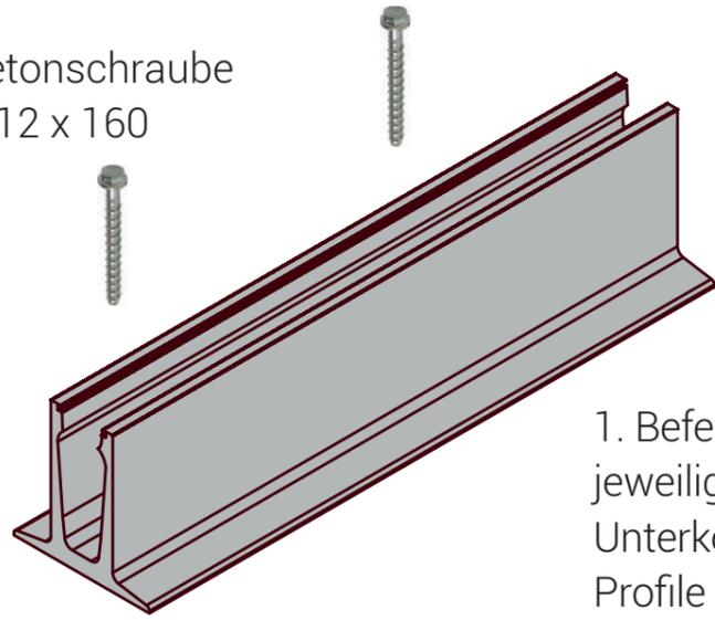
1. Befestigen Sie zunächst das Profil auf dem jeweiligen Untergrund. Richten Sie es an der Unterkonstruktion und nicht am Profil aus. Die Profile sind vorverformt und erst nach Einsetzen von Glas und Klemmstab korrekt ausgerichtet.
