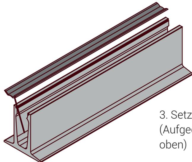
3. Setzen Sie den Klemmschuh ein. (Aufgedruckte Artikelnummer nach oben)
