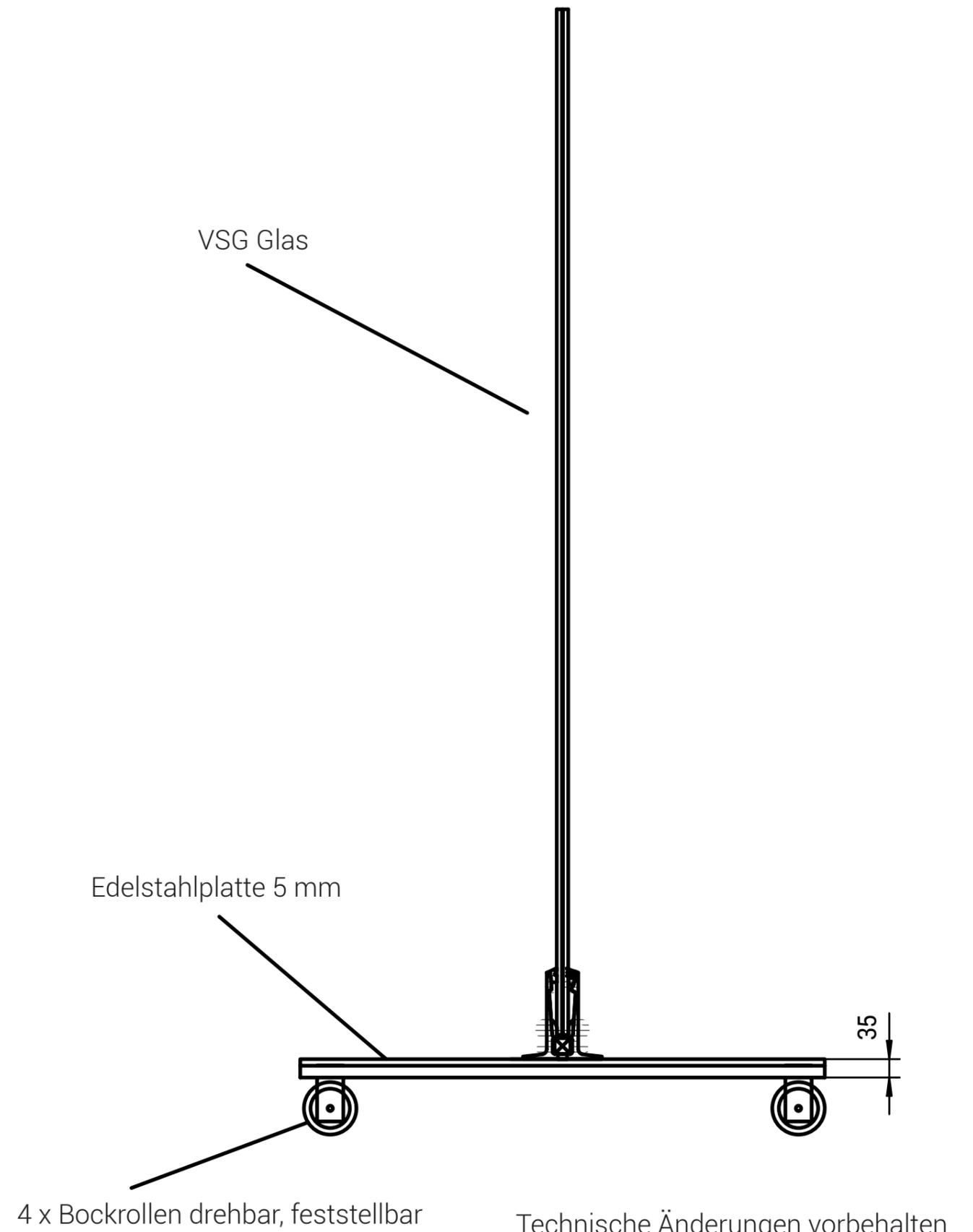
4 x Bockrollen drehbar, feststellbar
